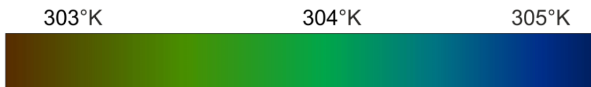
Рис. 7 Рабочий диапазон температур жидкокристаллической пленки
