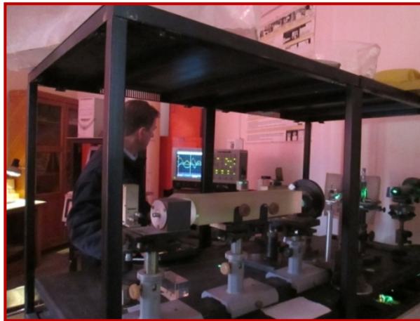
Рис. 2. Регистрации скорости свободной поверхности системой VISAR [1]
